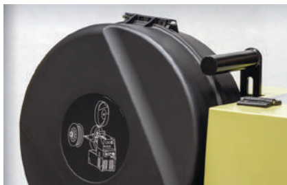
Защитный кожух подающего механизма
