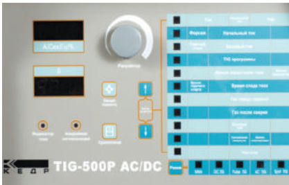
Цифровая многофункциональная панель управления
