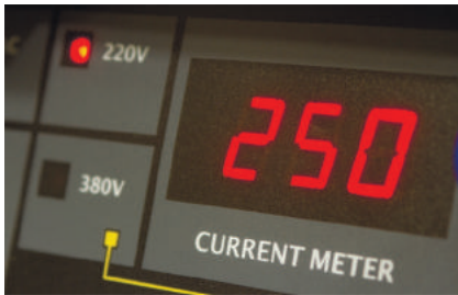
Цифровой дисплей для предустановки сварочного тока
