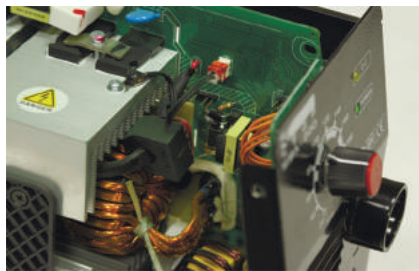
Компактное расположение электронных компонентов для снижения габаритов аппарата
