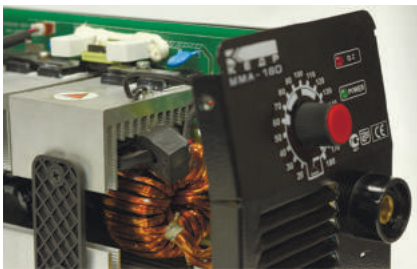
Тоннельная система охлаждения
