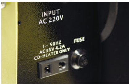
Розетка для подключения подогревателя газа
