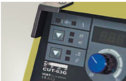
Кнопка переключения режимов работы плазмотрона (2Т-4Т)
