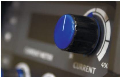
Плавная регулировка сварочного тока
