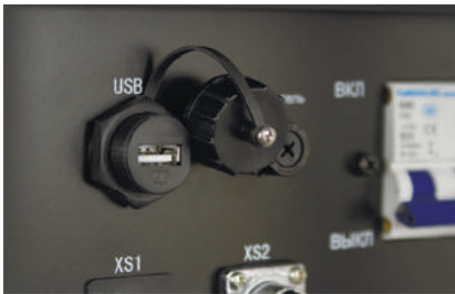
USB интерфейс для обновления программного обеспечения
