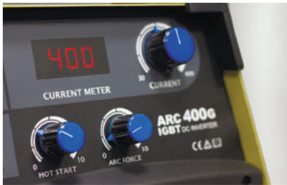
Ручная настройка горячего старта и форсажа дуги
