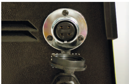
Разъем для подключения внешнего управления
