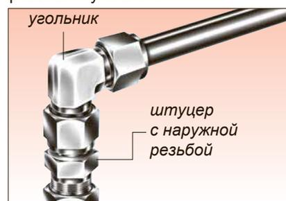
Соедините угольник со штуцером, затянув гайки S-Lok при помощи ключа и удерживая положение угольника в нужном направлении.
