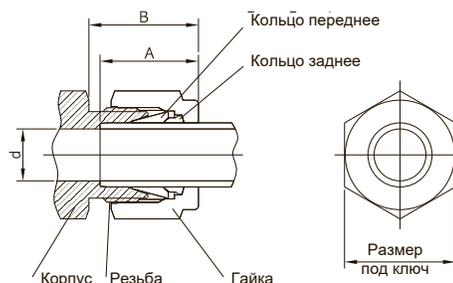
Труба бесшовная S-Lok из нерж.стали Ед.:мм
