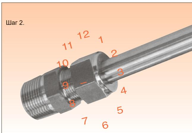
Затяните гайку на 1 и ¼ оборота ключом, удерживая при этом положение фитинга другим ключом неподвижно.
