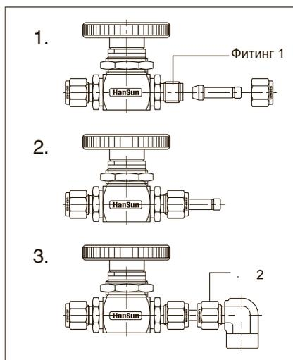
Ниппель S-Lok обеспечивает тесное соединение с другим фитингом.
