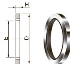
Металлическая прокладка обеспечивает уплотнение между обратным скосом соединения и лицевой поверхностью гнезда с внутренней резьбой.
