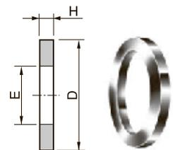
Прокладка устанавливается в плоскость внутренней резьбы. Лицевая поверхность наружной резьбы прижимается к прокладке, обеспечивая тем самым уплотнение.
